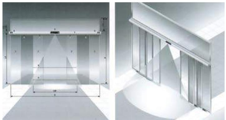
Automatische Teleskoportürsysteme sind ideale Systeme für enge Eingänge. Bei diesem System öffnen sich die Schiebeflügel mit relativer Geschwindigkeit übereinander. An Eingängen, an denen andere automatische Türsysteme nicht den erforderlichen Durchgangsraum bieten können, öffnen sich die Teleskopflügel übereinander und beseitigen so das Durchgangsproblem.
